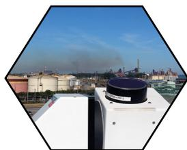
Périscope du lidar vent à balayage (Dunkerque, Halle aux Sucres).
